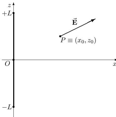
Le componenti del campo elettrico (nel vuoto) in un punto generico di coordinate  $(x_0, z_0)$ ,  $\mathbf{E}$  si possono valutare calcolando i due integrali, uno per ciascuna componente del campo:
